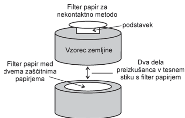
Slika 9.9: Prikaz merjenja totalne in matrične sukcije (Bulut in Leong, 2008).
