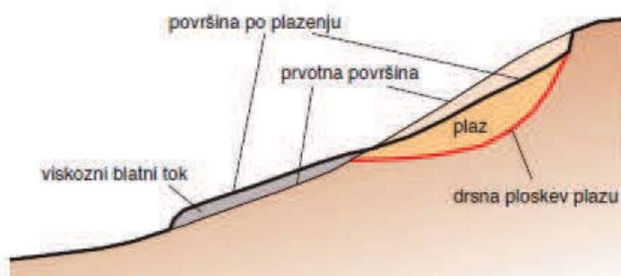
Slika 12.1: Mehanizem prehoda plazenja v viskozni blatni tok (Ribičič M., 2002b).
