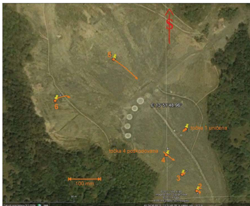
Slika 12.15: Lokacija geodetskih točk in pripadajoči pomiki točk.
