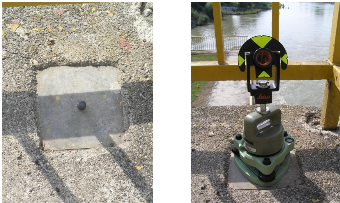
Slika 15: Stabilizacija in signalizacija kontrolne točke
