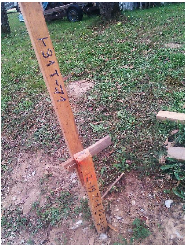
Slika 9: Primer zavarovanja točke (foto: Žnidaršič)
