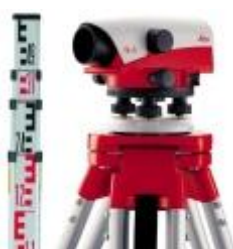
Slika 6: Nivelir Leica NA730 in teleskopska nivelmanska lata (Geoservis)
