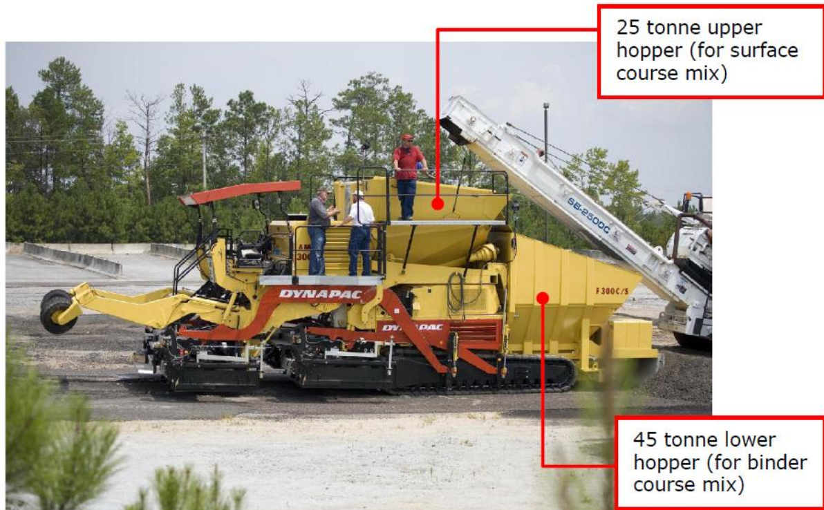
Slika 37: Asfaltni razdelilec za hkratno polaganje obeh plasti dvoplastnega PA (Morgan in sod., 2007)
