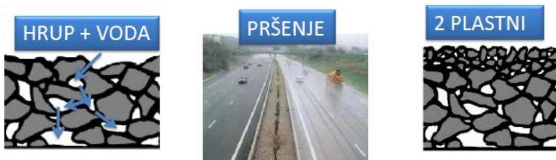
Slika 1: Prikaz prednosti porozne strukture (PA) in novi tip gradnje (Hribar, Žmavc, 2012)
