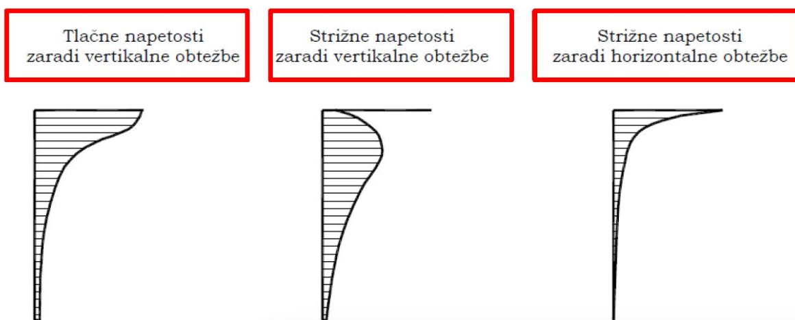
Slika 3: V voziščni konstrukciji nastopa več vrst napetosti (Hribar, Žmavc, 2012)
