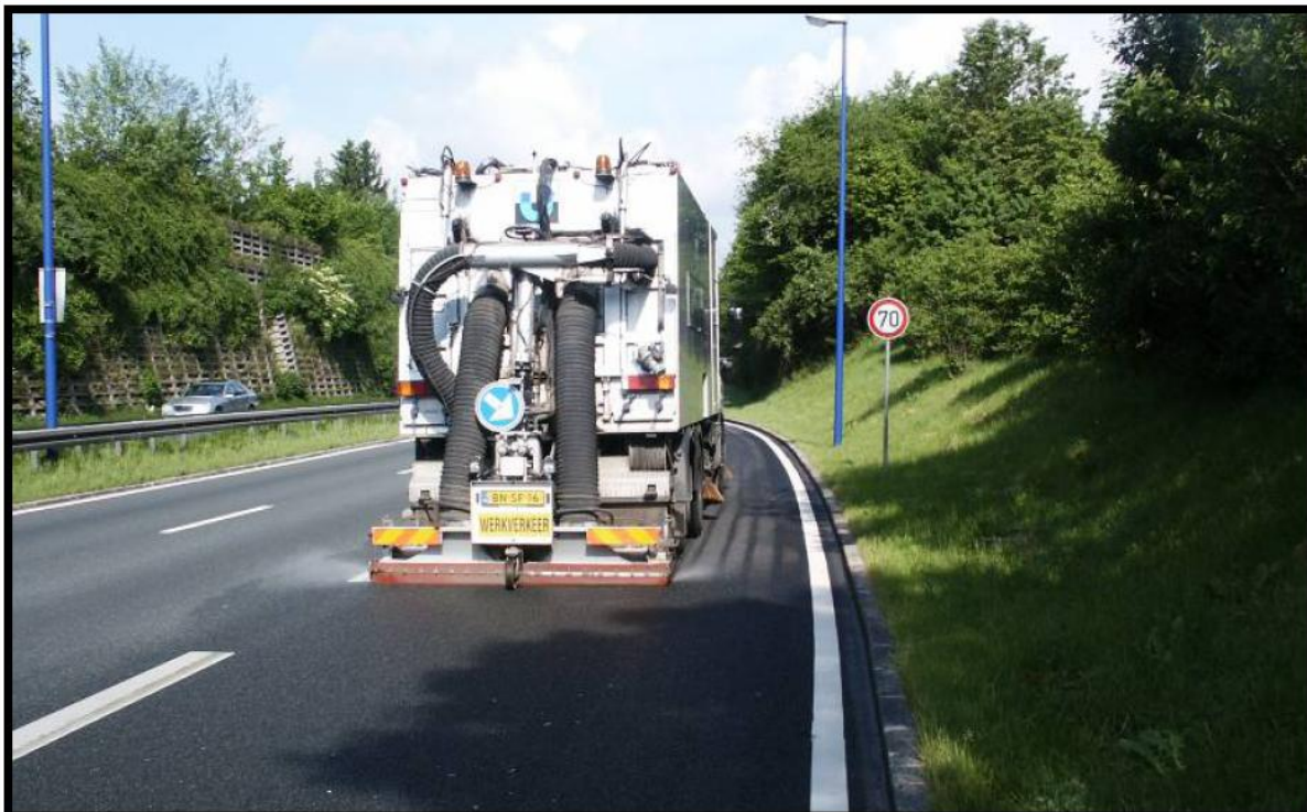
Slika 38: Prikaz strojne opreme za čiščenje PA (Attenberger, 2010)
