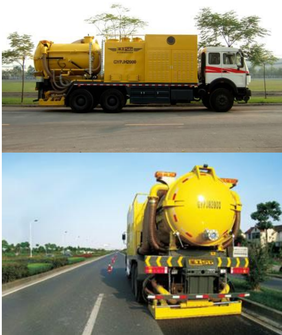
Slika 55: Strojna oprema za čiščenje PA proizvajalca Gaoyuan (Gaoyuan, 2012)
