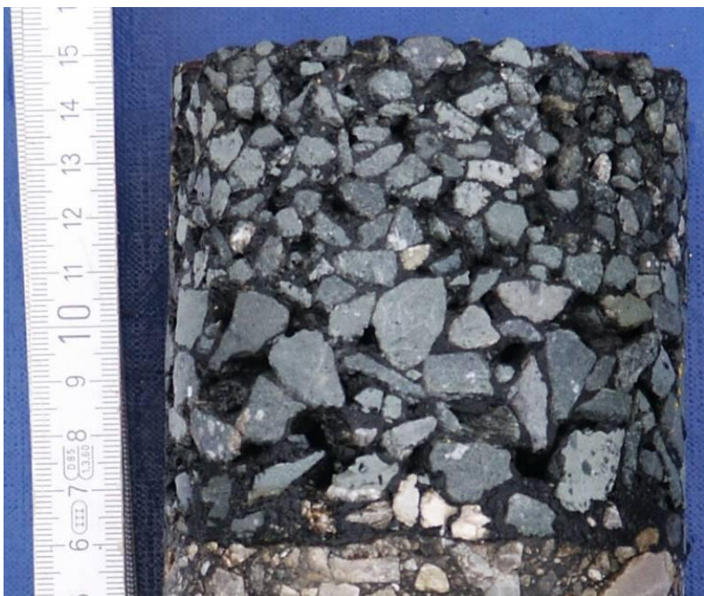
Slika 36: Prikaz izvrtanega jedra dvoplastnega drenažnega asfalta (Google, 2012)
