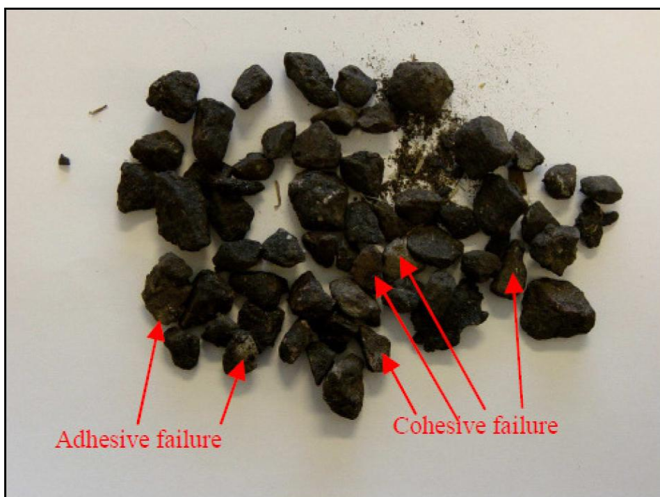
Slika 27: Odpadla zrna jasno nakazujejo tip poškodbe (Mohan, 2010)
