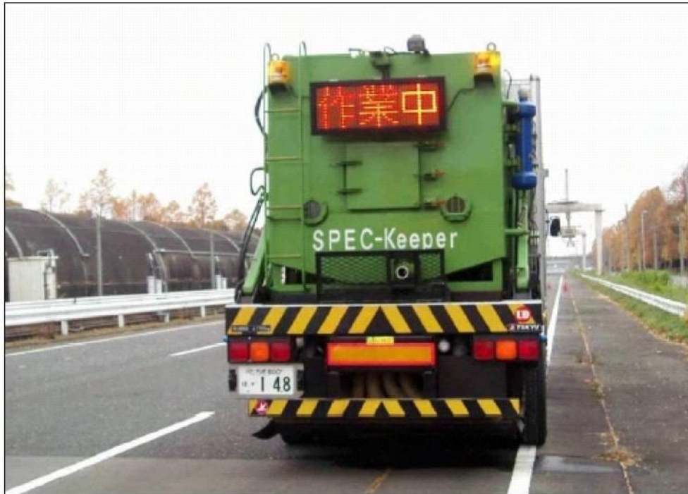
Slika 56: Japonska strojna oprema za čiščenje PA Spec – Keeper (Morgan in sod., 2007)
