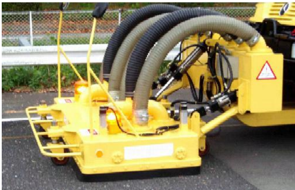
Slika 58: Japonska naprava za čiščenje PA samo s pomočjo zraka (Morgan in sod., 2007)
