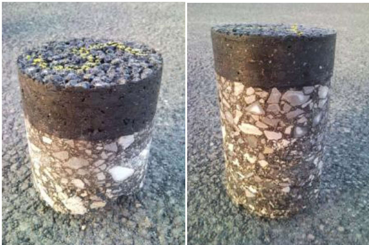
Slika 13: Razlika v deležu votlin v obrabni plasti je vidna s prostim očesom (levo PA, desno SMA) (Fortuna, 2011)
