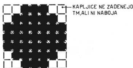
Slika 33: Rastrska pika v kapljičnem tisku in laserski elektrofotografiji
