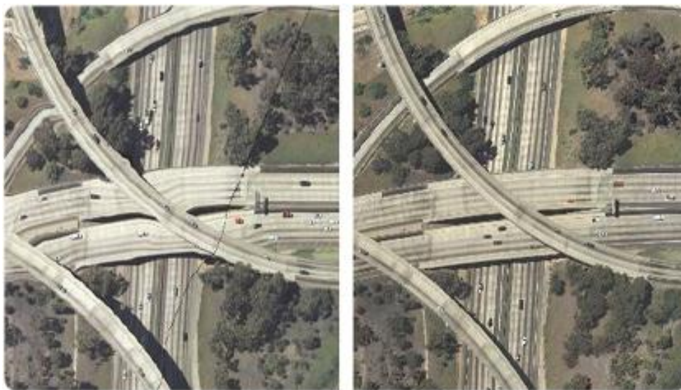
Slika 2: Deformacija mostu in nadvoza na klasičnem ortofotu ob uporabi DMR (levo) in pravilen prikaz na pravem ortofotu ob uporabi DMP (desno) (MJ Harden Associates, Inc., 2012)
