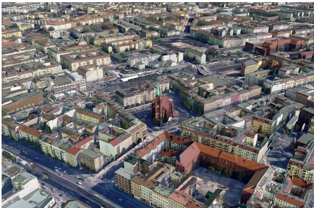
Slika 5: 3D model urbanega območja s podloženim popolnim ortofotom (virtualcitySYSTEMS GmbH, 2012)
