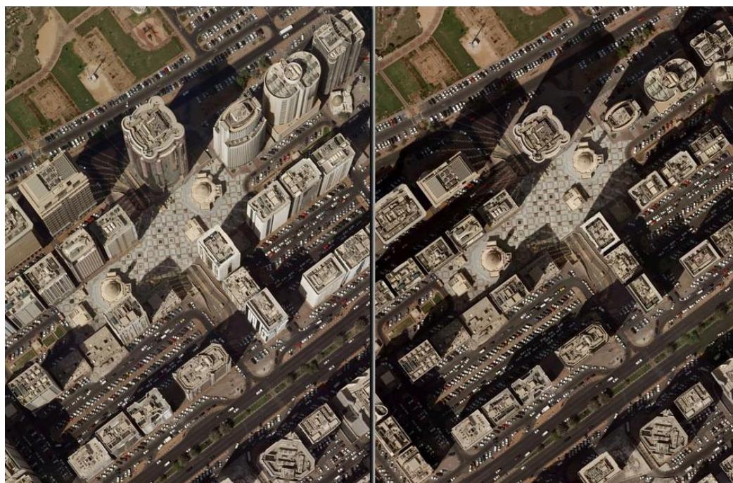
Slika 1: Primerjava klasičnega ortofota (levo) in popolnega ortofota (desno) (Space Imaging Middle East, 2012)
