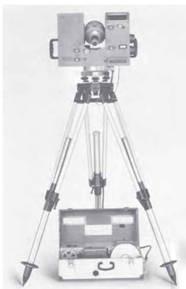
Slika 1: Tahimeter Zeiss RegElta 14 s sistemom za registracijo merjenih vrednosti in njegova uporaba na olimpijskih igrah v Münchnu leta 1972 (Opton, 1972)
