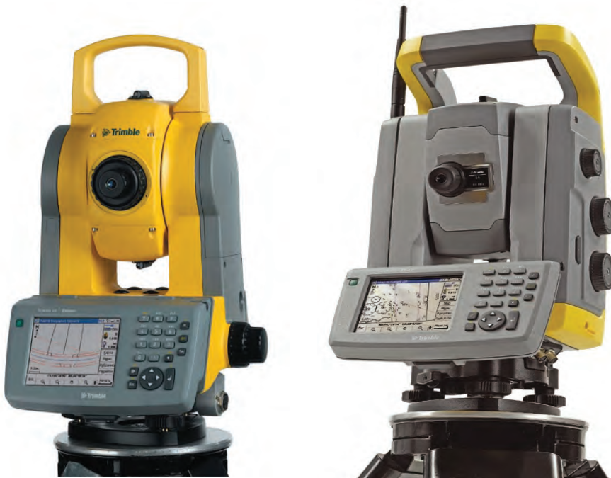
Slika 6: Tahimetra Trimble 3600 (URL 2) in Trimble S6 (URL 3)
