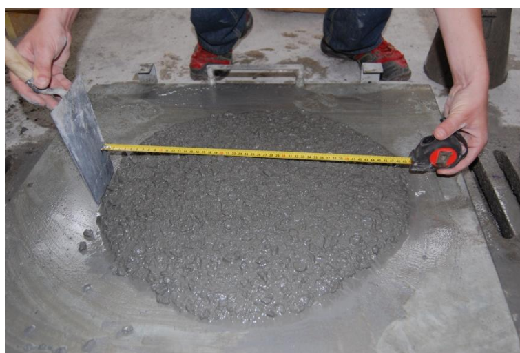
Slika 15: Merjenje razleza betonske mešanice
