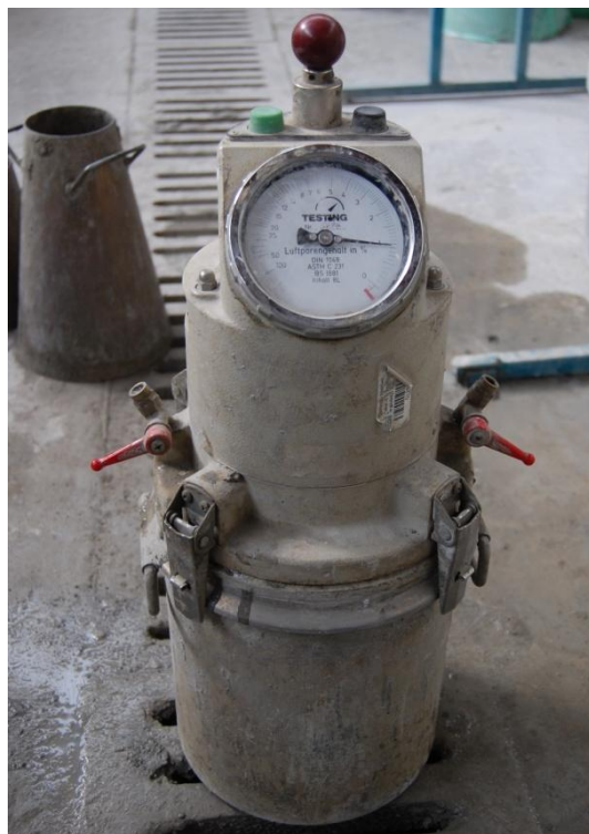
Slika 16: Naprava za merjenje vsebnosti zraka v betonu
