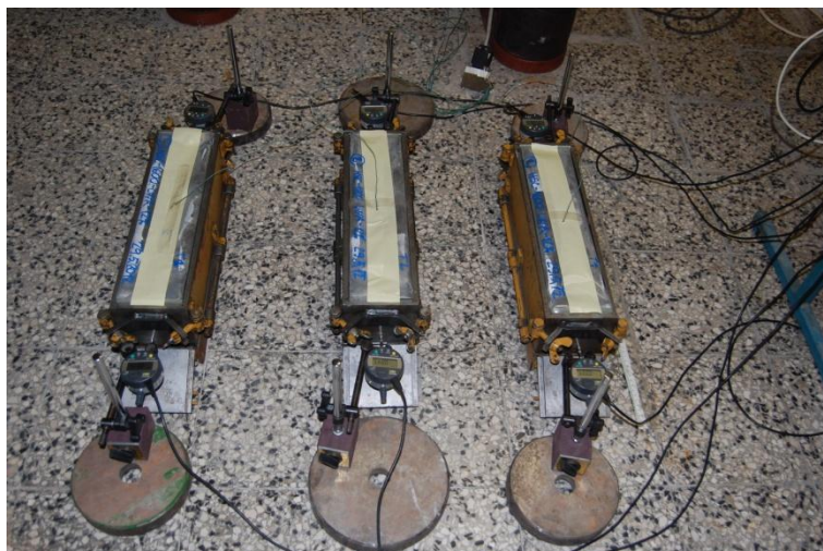
Slika 18: Elektronsko merjenje avtogenega krčenja preskušancev
