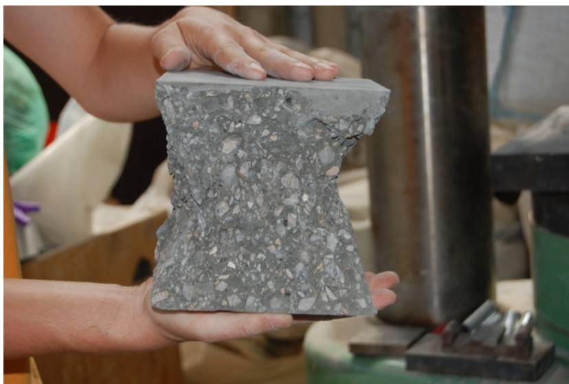
Slika 6: Porušen preskušavec HSC-1600-LWA-12% pri starosti 1 dan
