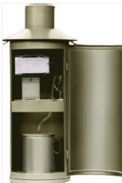
Slika 8: Pluviograf, s katerim pridobimo podatke o časovni razporeditvi padavin (Anemometerbau GmbH, 2012)
