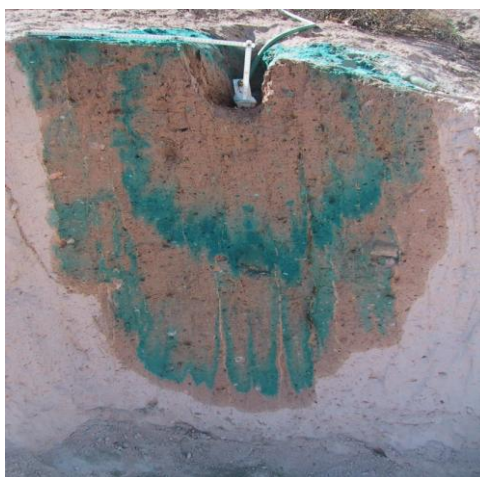
Slika 10: Simulacija infiltriranja vode v tla z prikazom front vlaženja (Povzeto po Tuller in Or, 2008)
