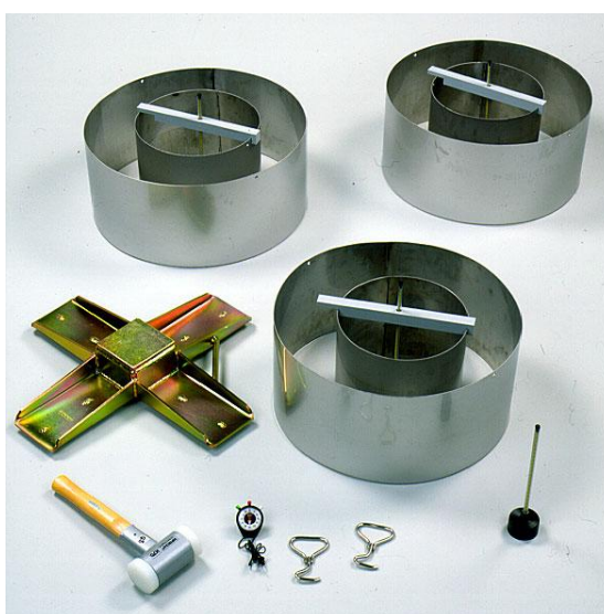
Slika 15: Primer infiltrometra z dvojnim obročem (Povzeto po Eijkelkamp, 2012)
