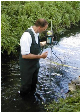
Slika 14: Prikaz meritve z napravo Flow Tracker handheld ADV merilec pretočnih hitrosti SonTek (AnHydre, 2012)
