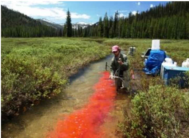
Slika 7: Prikaz merjenja hitrosti z sledilom rodamin (ASLO, 2008)
