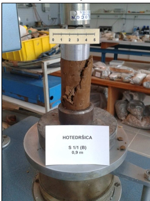
Slika 8: Porušitev vzorca pri enoosni preiskavi
