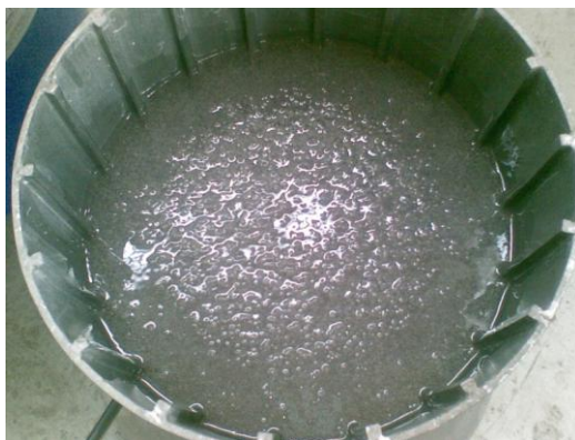
Slika 24: Zunanji valj (posoda) z vertikalnimi rebri (Op.: v posodi je olje)
