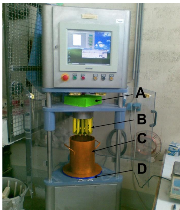
Slika 22: ConTec Viscometer 5. (Op.: Obarvano je zaradi lažje predstave)
