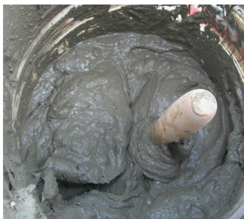
Slika 11: Preverjanje primernosti malte s terensko metodo zabadanja
