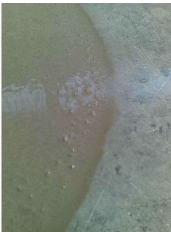
Slika 14: Izcejanje vode na robu sveže malte na udarni mizici
