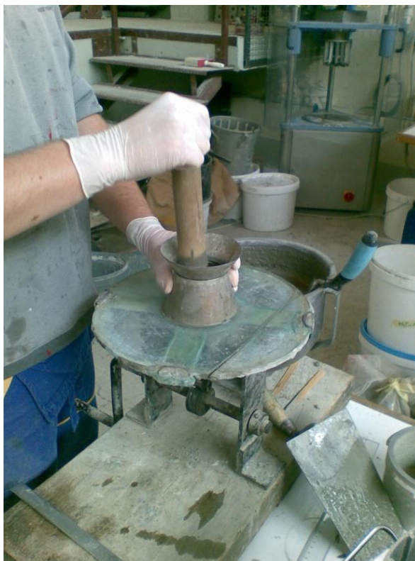
Slika 12: Zbijanje malte v stožcu na stresalni mizici
