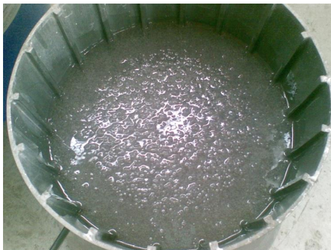
Slika 35: Zračni mehurčki v olju II po vlivanju v zunanji valj
