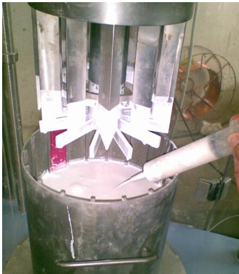
Slika 32: Merjenje dviga višine barve zaradi potopitve notranjega valja
