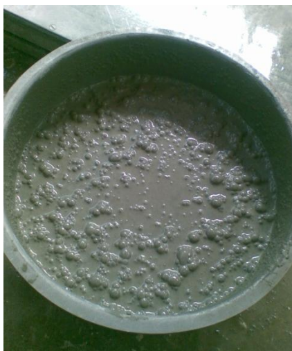
Slika 29: Segregirana malta s frakcijo agregata 0/4 po preizkusu v reometru
