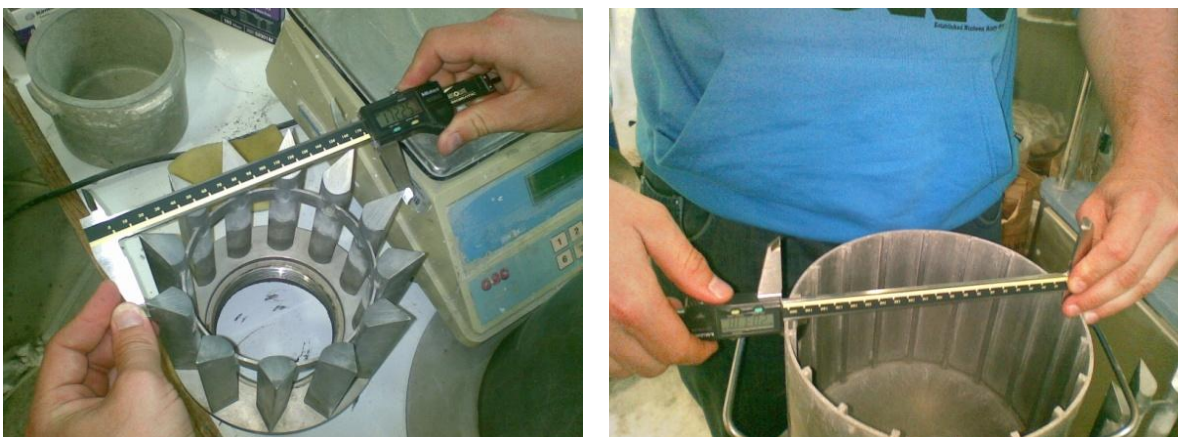
Slika 30: Meritev premera za vsako rebro na notranjem in zunanjem valju
