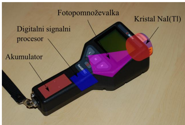
Slika 3: Shematski prikaz najpomembnejših sestavnih delov instrumenta
