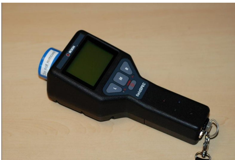
Slika 2: Ročni prenosni merilnik gama in nevtronskega sevanja FieldSPEC IdentiFINDER
