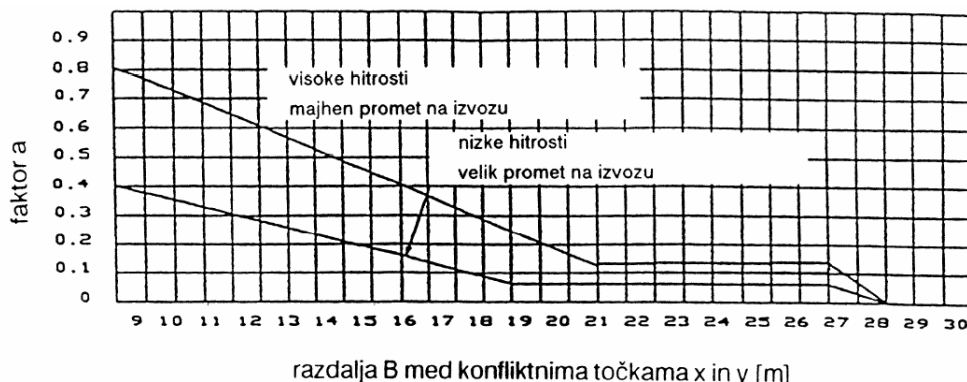
Slika 23: Določitev dejavnika a v odvisnosti od razdalje B in merodajnih prometnih razmer (TSC 03.341:2002: str. 17)
