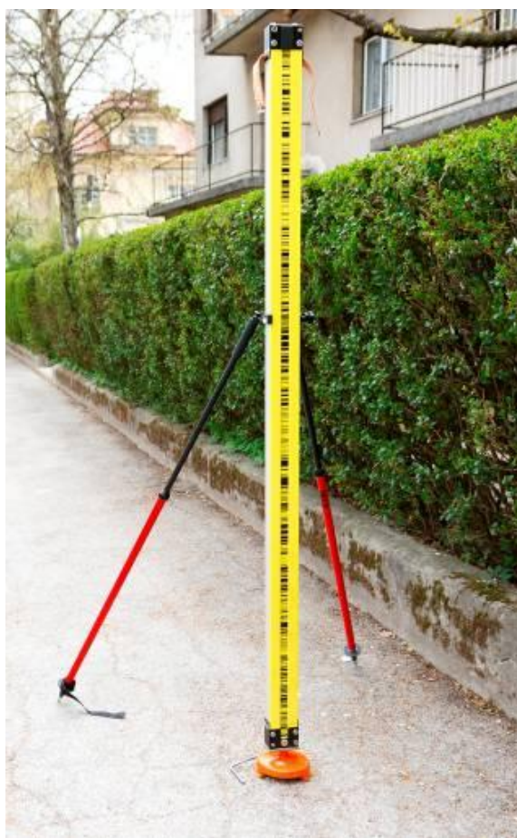
Slika 8: Invar nivelmanska lata vpeta v stojalo in podložka
