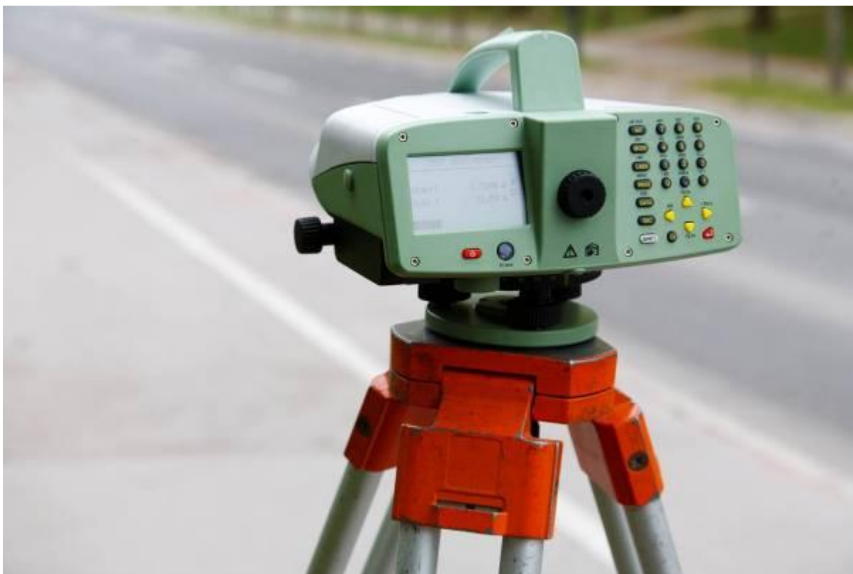
Slika 5: Digitalni nivelir Leica DNA 10
