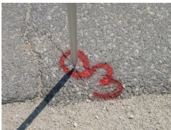
Slika19: Stabilizacija izmeritvene to ke s kovinskim žebli kom
