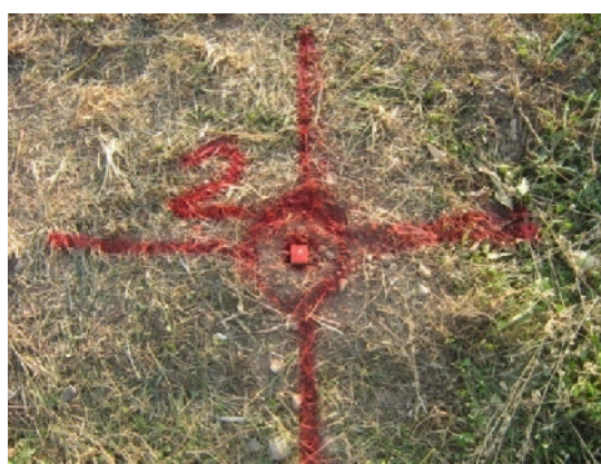
Slika20: Stabilizacija izmeritvene to ke z lesenim koli kom
