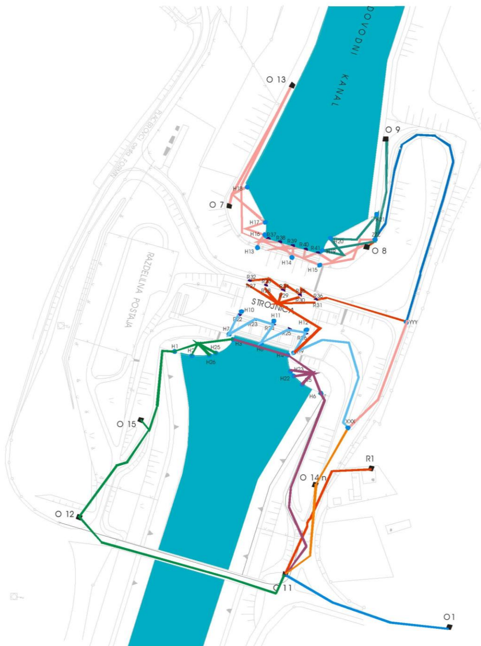
Slika 3: Skica nivelmanske mreže in nivelmanskih zank hidroelektrarne Formin
