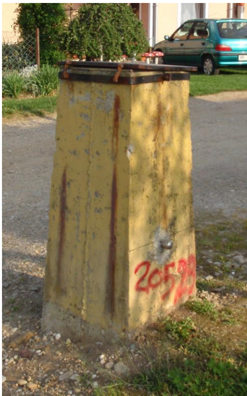
Slika 9: Reper RRN na stebru O1
