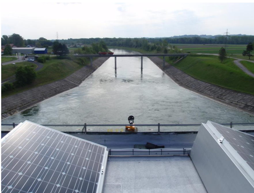
Slika 14: Kontrolna točka H11 na strojnici, signalizirana s preciznim reflektorjem
