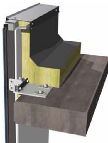
Slika 5: Trodimenzionalni model stika strešne plošče s Qbiss Air panelom
