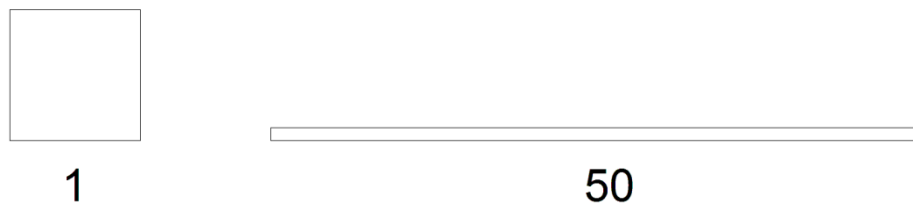
Slika 41: Razmerje stranic štirikotnega končnega elementa
