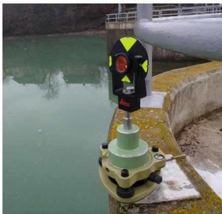
Slika 12: Signalizacija detajlne točke na pregradi (Kogoj, 2010)
