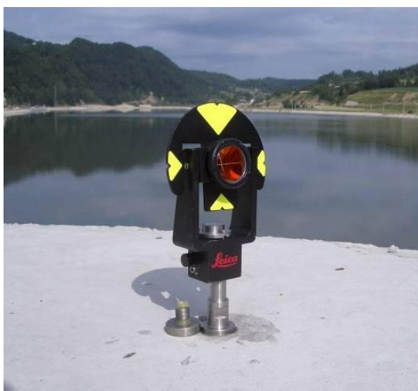
Slika 21: Signalizacija kontrolnih točk v mreži hidroelektrarne Boštanj (Kogoj, 2010)
