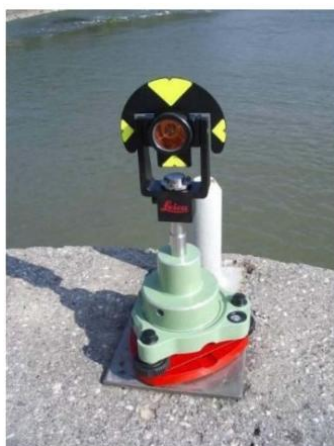
Slika 15: Primer signalizacije kontrolne točke na pregradi (Kogoj, 2010)
