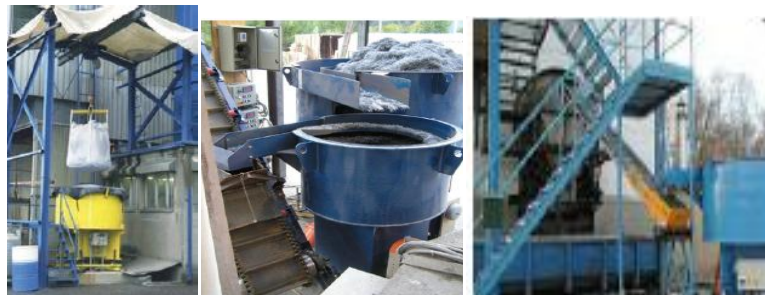
Slika 29: Avtomatizirani dozirni sistem jeklenih vlaken s posebno cilindrično napravo
