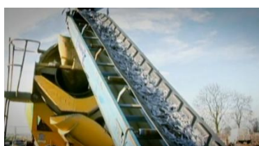
Slika 26: Jeklena vlakna po tekočem traku pridejo v boben avtomešalnika
