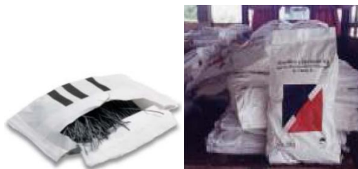
Slika 5: Vodotopen zavoj jeklenih vlaken (levo) in vlakna v vodotopnih vrečah (desno)
