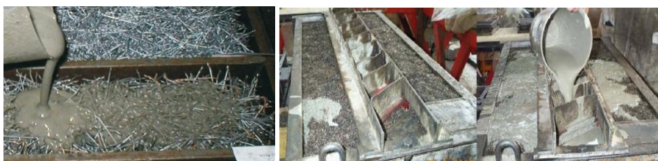
Slika 54: Izlivanje redke cementne paste neposredno na jeklena vlakna v opažu
