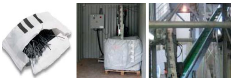
Slika 31: Vodotopni zavoj jeklenih vlaken (levo), verižno povezani zavoji (v sredi), magnetni transport verižnih zavojev v mešalec (desno)
