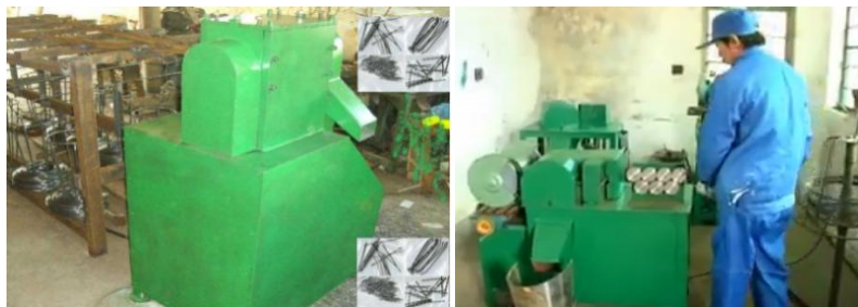
Slika 3: Ena izmed naprav za izdelavo nekaterih zgoraj naštetih tipov oziroma oblik jeklenih vlaken
