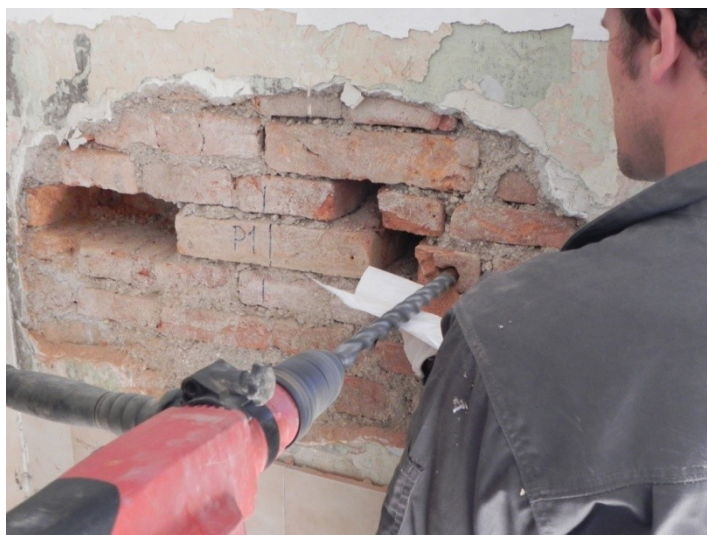
Slika 19: Prikaz odvzemanja vzorca za ugotavljanje vlažnosti opeke
