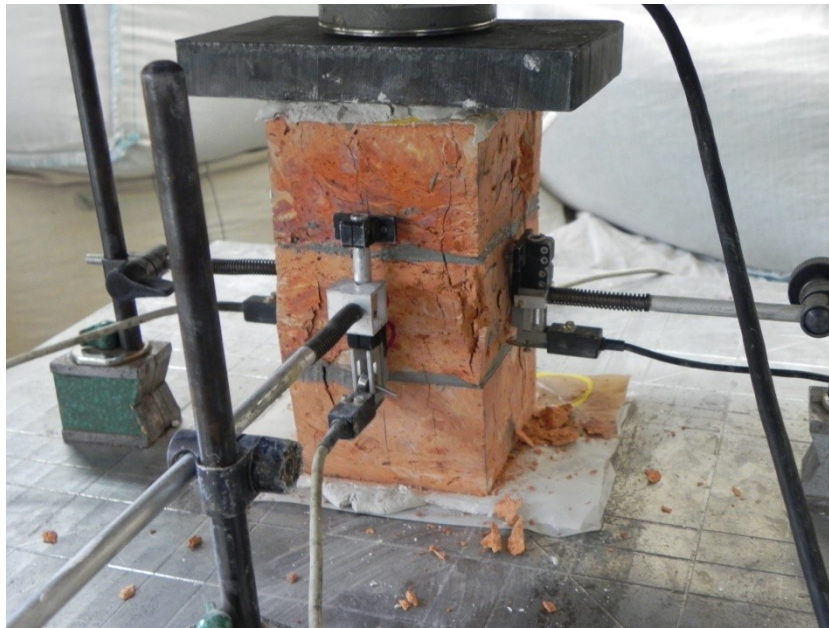
Slika 34: Porušitev opečne prizme P3
