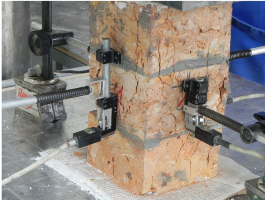
Slika 32: Porušitev opečne prizme P1
