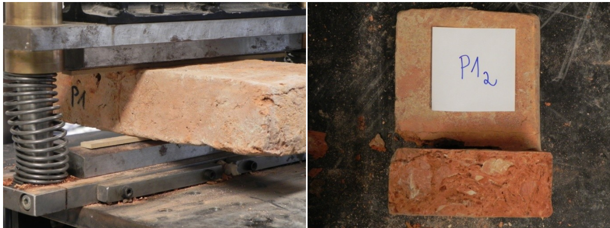
Slika 18: Opeka med in po obremenitvi
