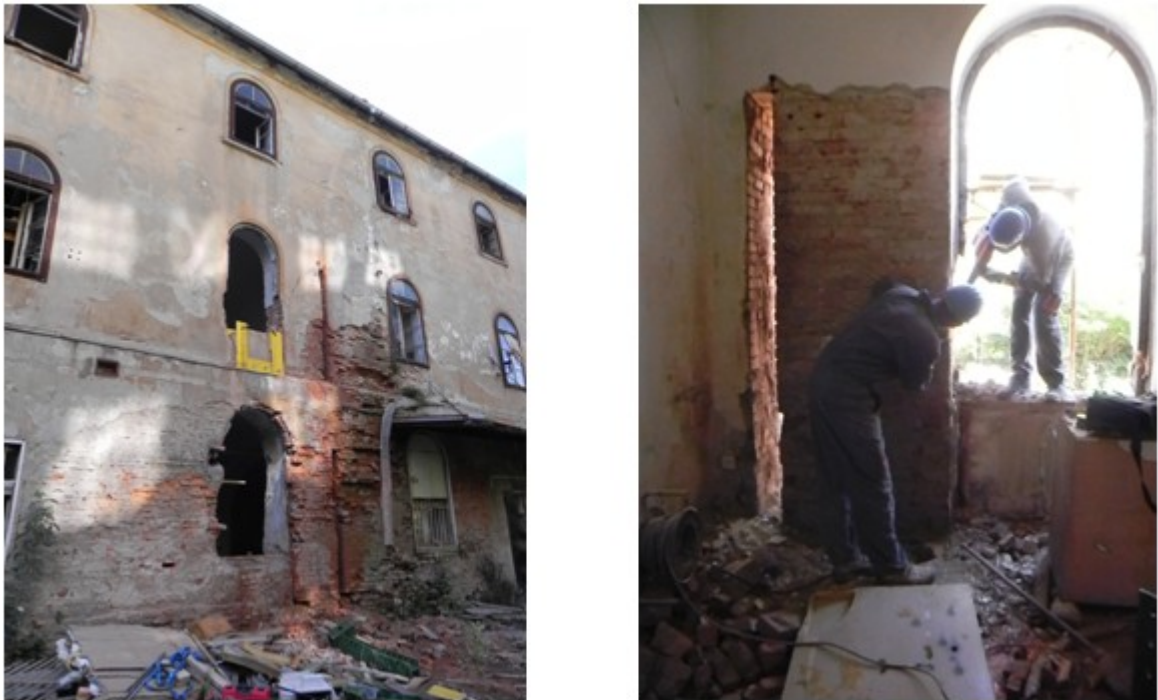
Slika 23: Lokacija izvedbe strižnih testov in prikaz priprave na strižni test
