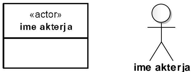
Slika 8: Primera različnih notacij za stereotip
