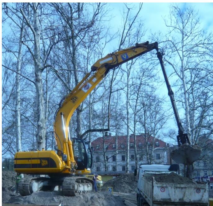
Slika 36: Bager s podaljšano roko grabilca (Swietelsky, 2010)
