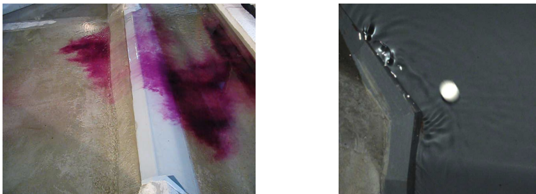
Slika 12: (a) Vizualizacija toka z barvilom, (b) vrtinci ob modelnem krilnem zidu (prikazan tudi bel okrogel plastični plovec)
