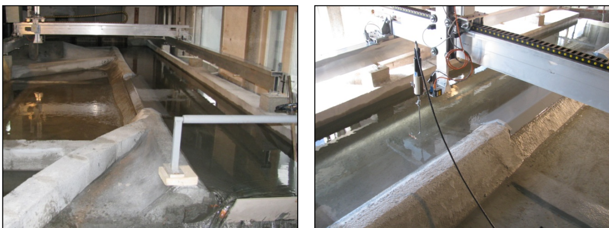
Slika 11: Fizični model razbremenilnega objekta: (a) pogled z dolvodne strani, (b) ADV sonda na merilnem mostu
