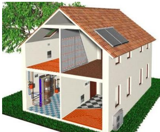
Slika (privzeta) 11: Sekundarni tokokrog v hiši - talno in stensko ogrevanje (Evrotrade, 2012)
