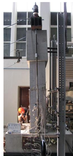
Slika C.7: Upogib stebra pri pomiku na vrhu u = 80 mm
