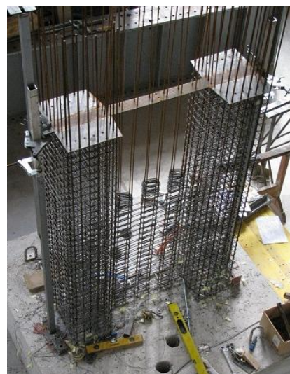
Slika C.1, C.2: Izdelava armaturnega koša modela stebra
