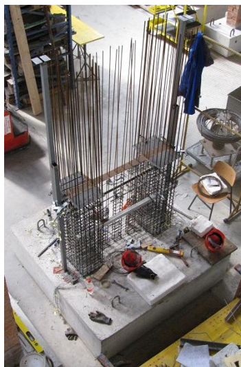
Slika C.1, C.2: Izdelava armaturnega koša modela stebra
