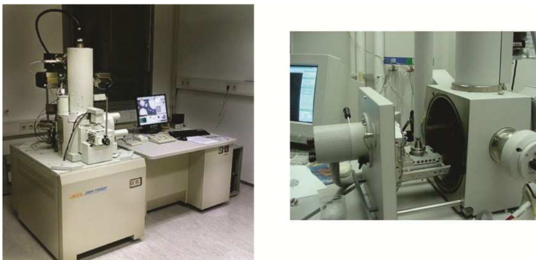
Slika 10: SEM (levo) in vakuumsko jedro (desno) (Biotehniška fakulteta, 2010; wikipedia, 2011)
