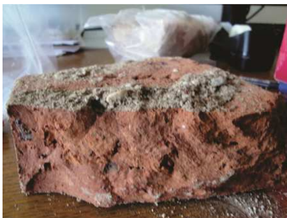
Slika 13: Prikaz priprave zbruska za mikroskopiranje
