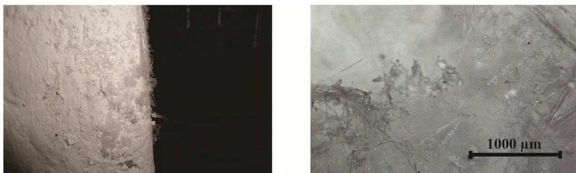
Slika 22: Opažene soli na steni na drugem merilnem mestu (levo) in multi-fokus slika le-teh pri 100x povečavi (desno)
