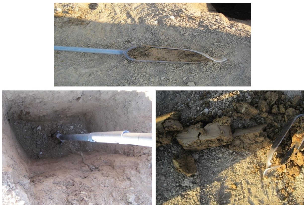
Slika 17: Talni profil na parceli 601/1 v k.o. Lahovče – uporaba sonde
