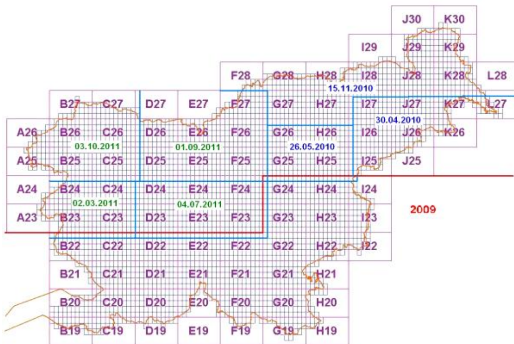
Slika 14: Obnova dejanske rabe po trigonometričnih sekcijah – načrt izdelave DOF [44]
