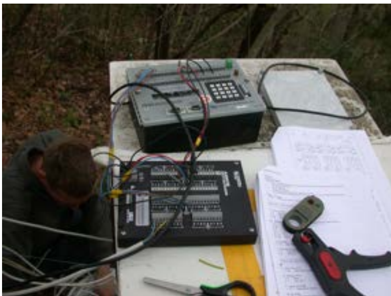
Slika 20: Del merilne opreme je tudi zapisovalec podatkov, ki zapisuje in shranjuje izmerjene podatke v izbranih časovnih razmikih
