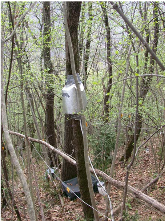
Slika 19: Zaščita senzorjev pred zunanjim segrevanjem z aluminijasto folijo
