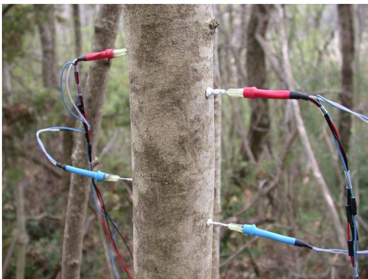
Slika 17: Senzorji na vzhodni in zahodni strani debla na višini 1.3 m, t.i. »breast high«
