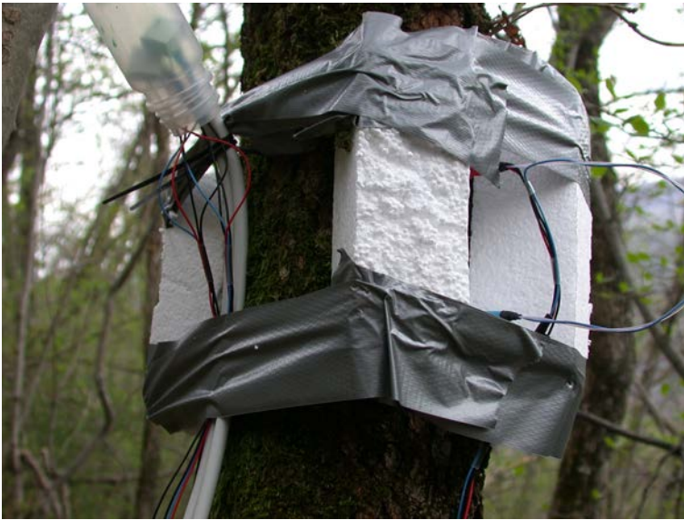
Slika 18: Zaščita senzorjev pred mehanskimi poškodbami s stiroporjem
