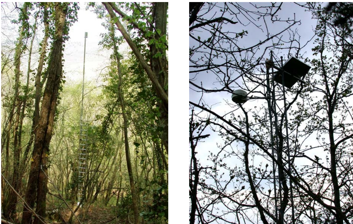
Slika 13: Hellmanov dežemer (levo), ombrograf in sončne celice (desno)
