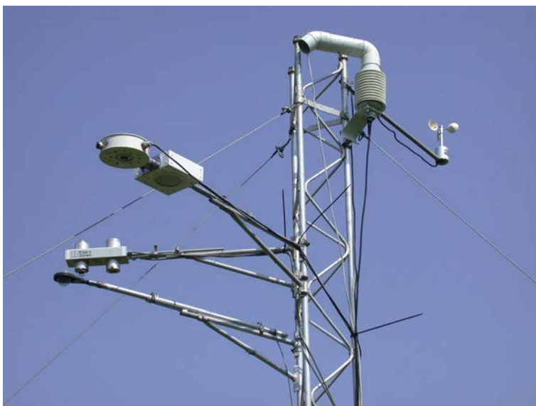
Slika 14: Merjenje neto sevanja, dosepelega in odhodnega kratkovalovnega sevanja, neto sevanja, dosepelega in odhodnega dolgovalovnega sevanja, temperature, relativne vlažnosti zraka ter hitrosti in smeri vetra na meteorološki postaji Sveti Štefan
