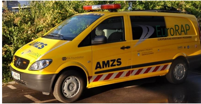
Slika 5: Specialno vozilo, namenjeno snemanju cestne infrastrukture
