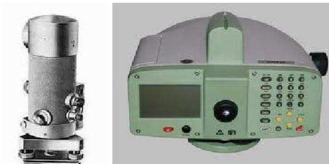
Slika 5.2: Precizni nivelir Carl Zeiss Koni NI007 in Leica DNA 03 (URL 9, URL10, 2012).
