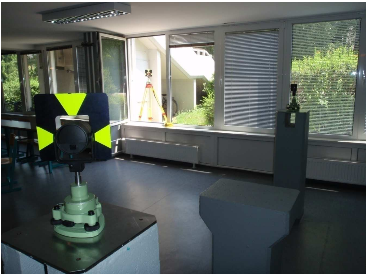
Slika 4.3: Prikaz stebrov 4 levo in 3 desno s pritrjenimi prizmami. Vmes je steber R_{Fgg} .
