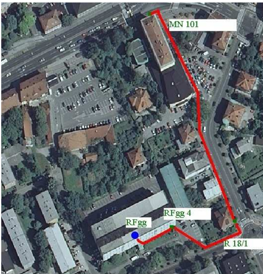
Slika 5.1: Potek nivelmanskega vlaka in položaj reperjev (URL 1, 2012).
