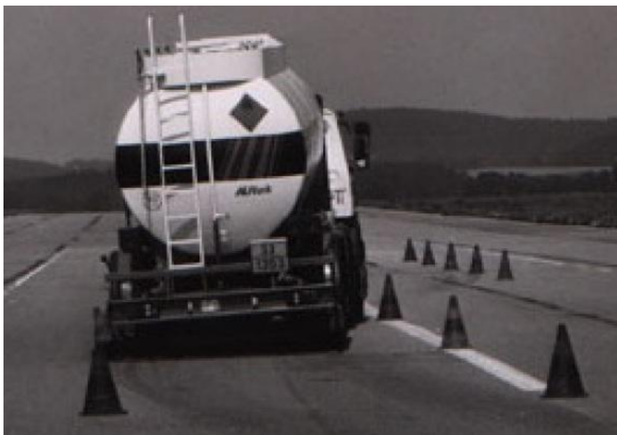
Slika 21: Prikaz fizičnega modela v naravni velikosti med izvedbo manevra menjave voznega pasu (Casasanta, 2010).
