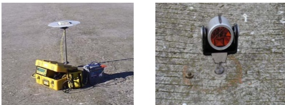
Slika 3.8: Stabilizacija in signalizacija referenčnih točk
