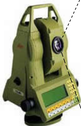
Slika 3.10: Leica Geosystems TC2003, (www.nsscana.com)
