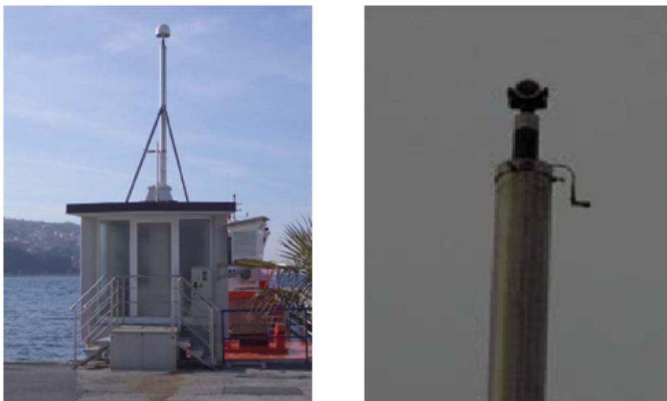
Slika 3.7: Signalizacija točke KOPE za potrebe GPS in klasične terestrične izmere
