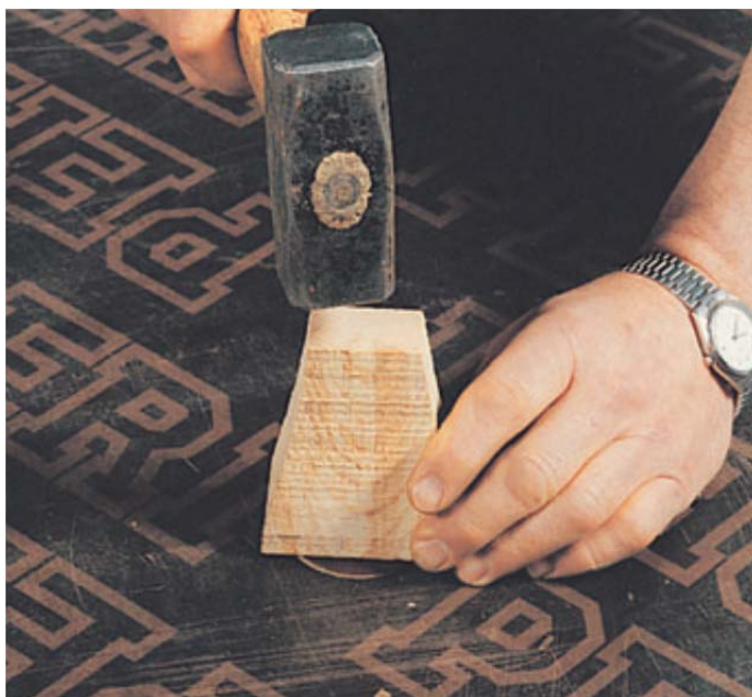
Slika 18: Popravilo vezane plošče z diski (TRIO, 2011, str. 29)
