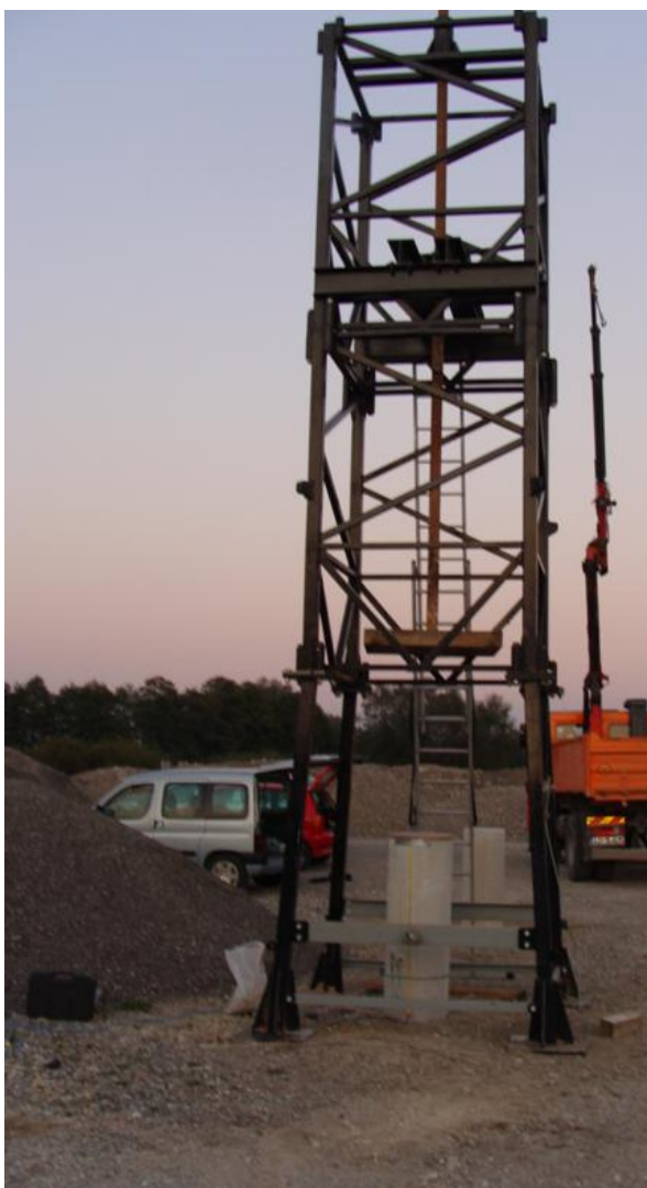
Slika 24: Izvedba stolpa za dvig uteži
