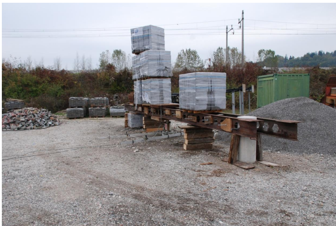
Slika 21: Izvedba konstrukcije za zagotovitev reakcijske sile
