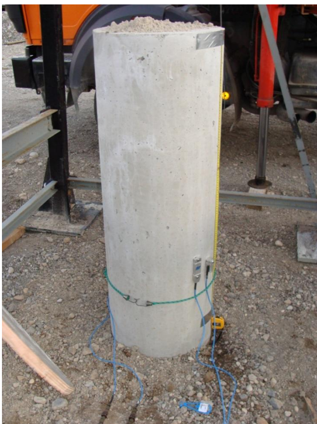
Slika 25: Namestitev merilnikov na pilot pred pričetkom dinamičnega obremenilnega testa
