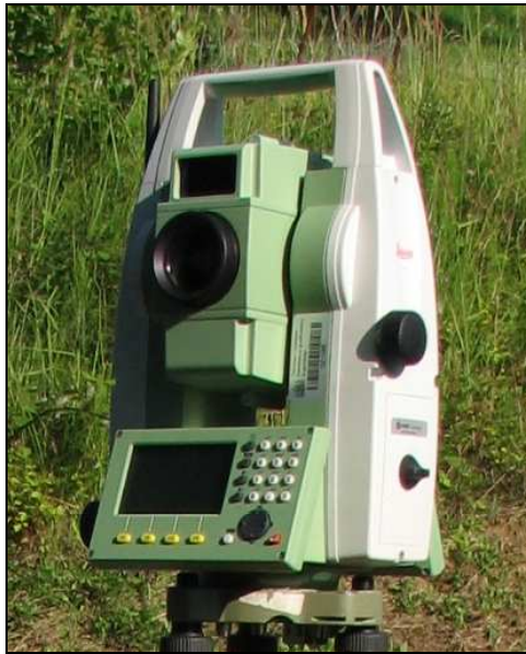
Slika 10: Elektronski tahimeter Leica Flexline TS06
