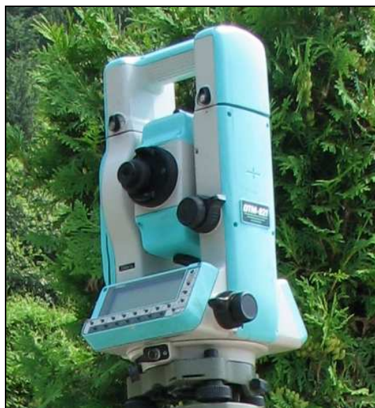
Slika 9: Elektronski tahimeter Nikon DTM 821
