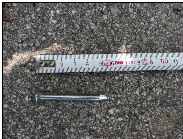
Slika 6: Klin za stabilizacijo referenčnih točk
