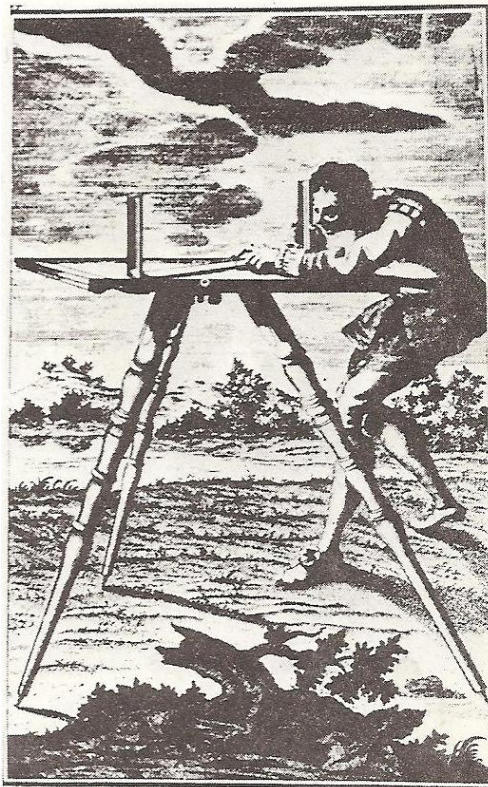
Slika 2: Prikaz merjenja z mersko mizo (Korošec, 1978)
