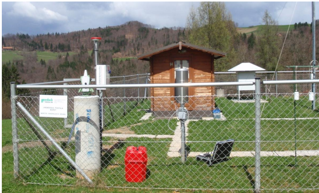
Slika 22: Prostor s kontrolno postajo; levo točki III-GPS in GMX1, v ozadju lopa z nadzorno računalniško postajo, v ospredju in desno merilniki meteoroloških parametrov, 2011.
