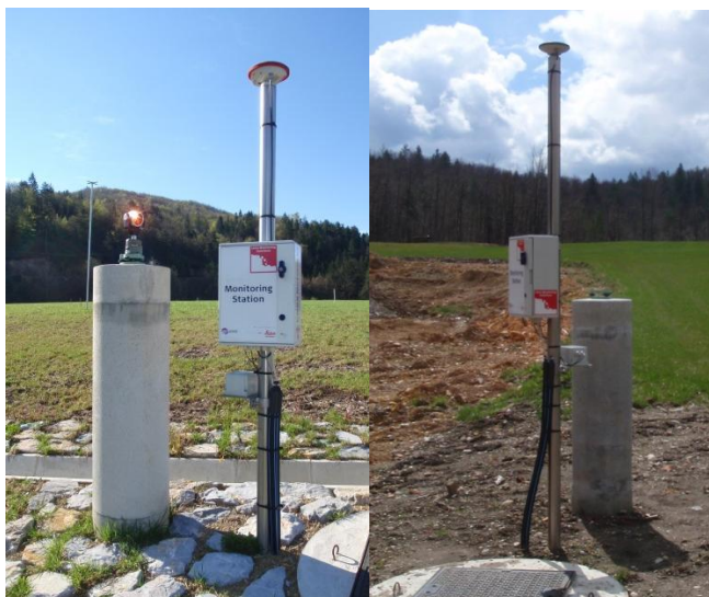
Slika 16: Primer stabilizacije: od leve proti desni točki II-GPS in GMX2 (levo) ter GRS1 in V-GPS (desno).
