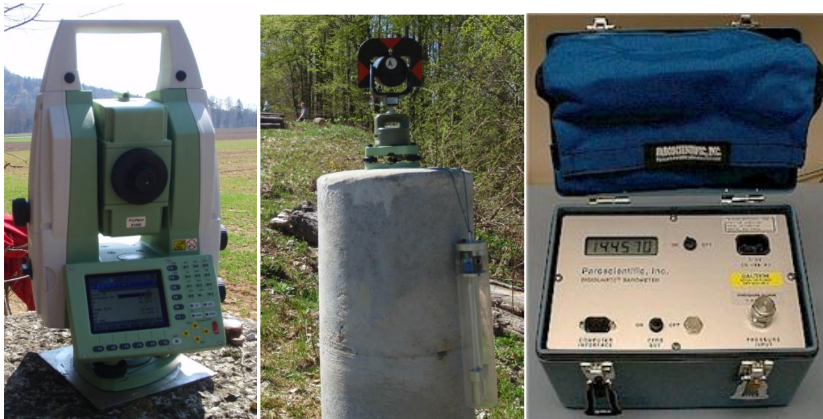
Slika 21: Leica Geosystems TS30 R1000 (levo), aspiracijski psihrometer ob stebru in reflektor na stebru (na sredini), digitalni barometer Paroscientific 760-16B (desno).
