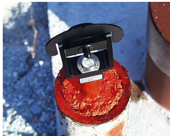
Slika 11: Stabilizacija in signalizacija kontrolne točke [24]
