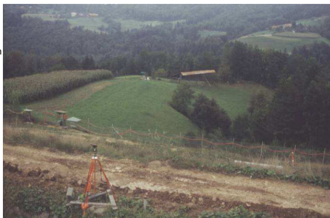
Slika 10: Stabilizacija kontrolnih točk odlagališča [24]
