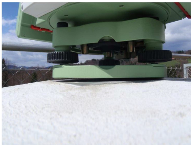
Slika 9: Nehorizontálnost kovinske plošče na vrhu [19]
