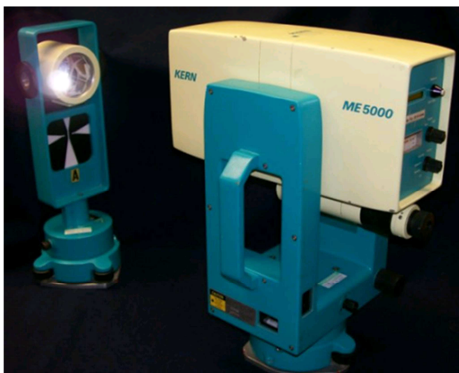
Slika 13: Razdaljemer mekometer ME5000 [27]
