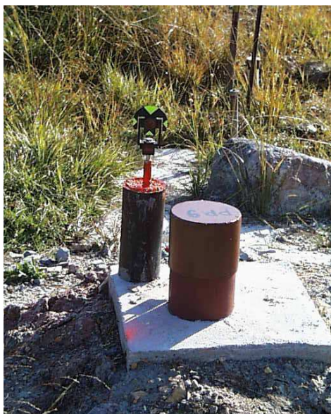
Slika 11: Stabilizacija in signalizacija kontrolne točke [24]
