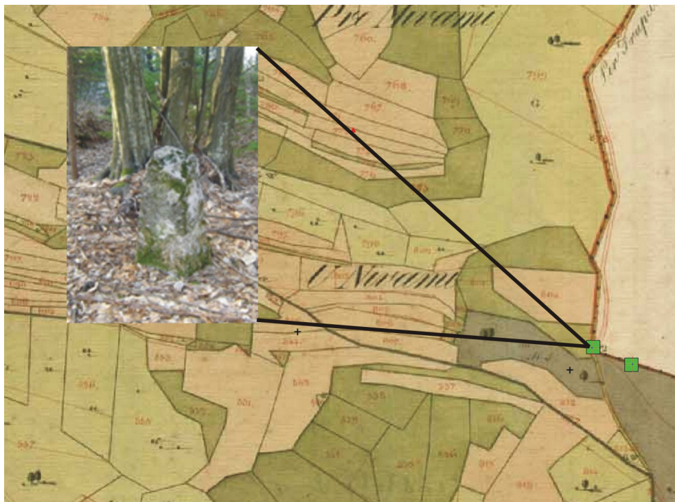
Slika 2: Identifikacija stabiliziranih točk na terenu, ki ustrezajo »katastrskim« točkam starih katastrskih načrtov grafične izmere v delu k. o. Žažar.
