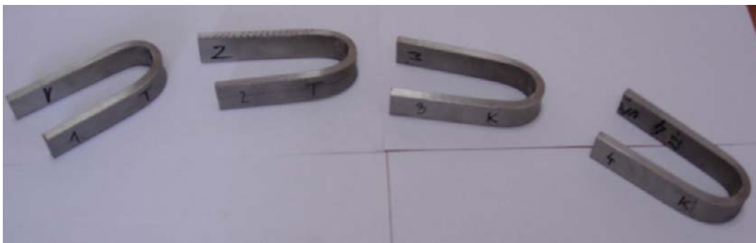
Slika 33: Upogibni preizkušanci (2 temenska in 2 korenska) po preizkusu
