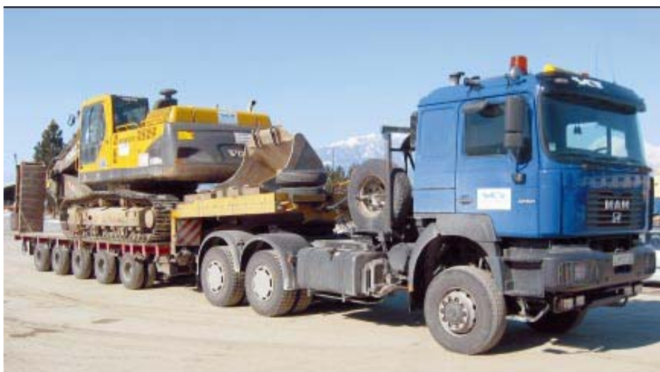
Slika 13: Vlačilec MAN 33.604 s 50 - tonsko nizkonosečo polprikolico in izrednim tovorom bagrom VOLVO EC 360 BNLC
