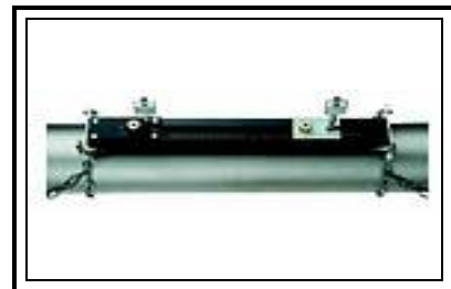
Slika 22: Prikaz postavitve merilnih sond ultrazvočnega merilnika UFM 610 P
