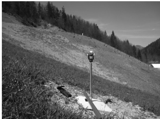
Slika 5: Prilno centriranje reflektorja za terestrično izmero
