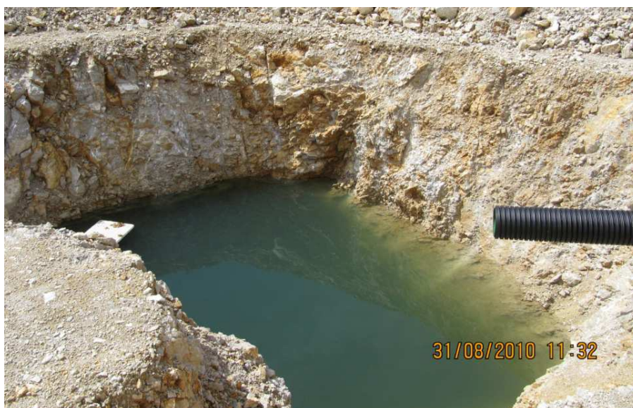
Slika 13: Kontrola ustreznosti terena za izvedbo ponikovalnega polja
