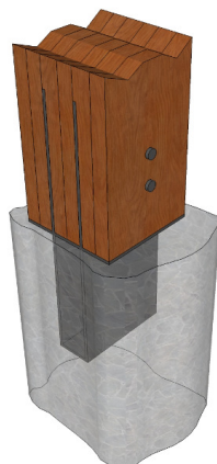
Slika 25: Izbran način sidranja stebrov v betonsko steno
