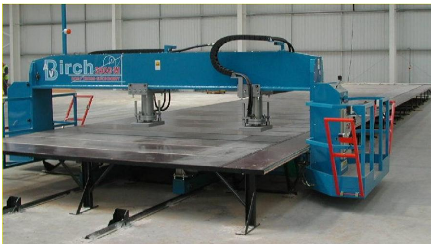
a) stiskalnica velikega formata v proizvodnem obratu prefabriciranih lesenih elementov [8].
